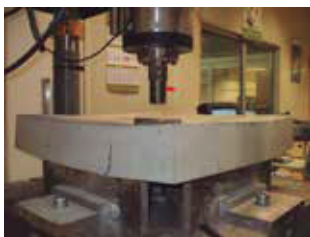
Ensayo de absorción de energía en laboratorio.
