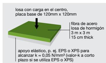
El día después de la prueba hasta alcanzar el fallo, la mayoría de las fisuras estaban cerradas de nuevo, lo que prueba el concepto del alambre 5D.
